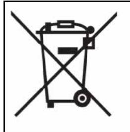
Das am Gerät angebrachte und nebenstehend illustrierte Symbol weist darauf hin, dass das Produkt der getrennten Sammelpflicht von Elektrogeräten unterliegt.
