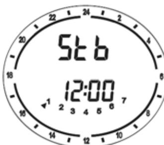
**Atención:** en esta posición, de todos modos, el radiador es alimentado eléctricamente.
